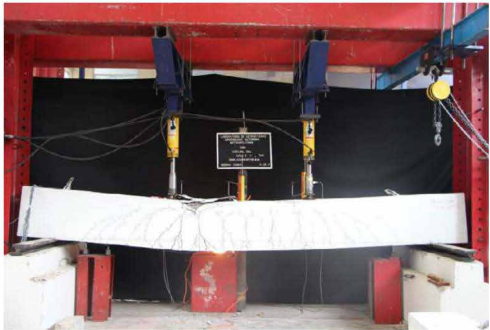
Figura 31. Agrietamiento del espécimen V02 al final del ensaye.
