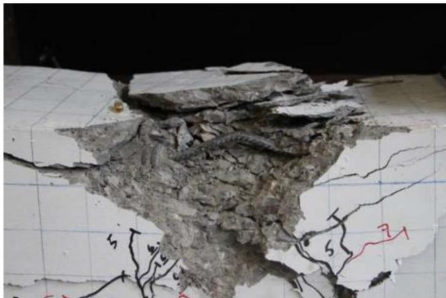
Figura 30. Detalle del desconchamiento y pandeo de barras del espécimen V01.
