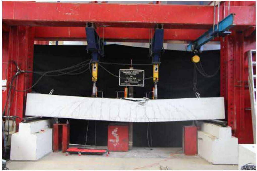
Figura 35. Agrietamiento del espécimen V04 al final del ensaye.
