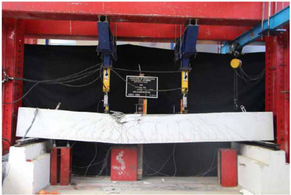
Figura 33. Agrietamiento del espécimen V03 al final del ensayo.
