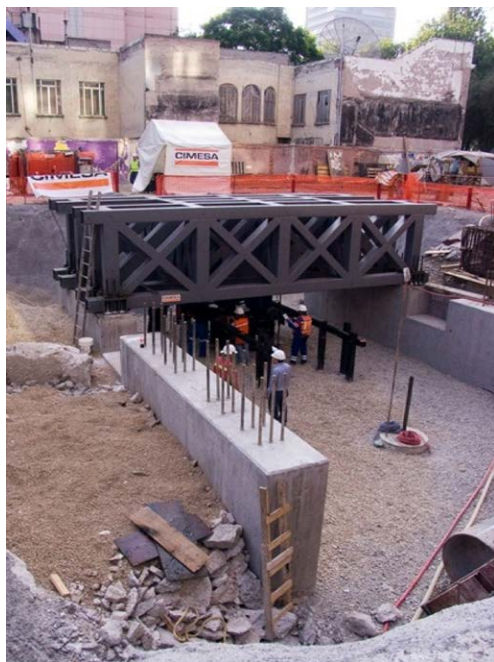
Figura 6. Armadura de reacción colocada sobre la primera pila de prueba, y acercamiento mostrando gatos hidráulicos y estructura de referencia.
