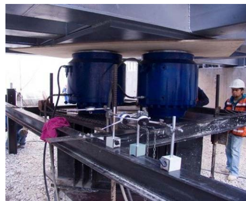
Figura 6. Armadura de reacción colocada sobre la primera pila de prueba, y acercamiento mostrando gatos hidráulicos y estructura de referencia.
